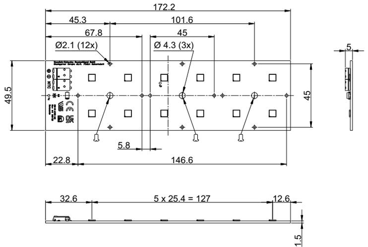
Alle Löcher mit  $\varnothing 2,1$  mm sind Befestigungslöcher für Optiken. | Alle Löcher mit  $\varnothing 4,3$  mm sind Befestigungslöcher für die Platine.
