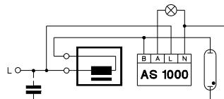
Пусковой переключатель для НМ ламп с вспомогательной лампой
