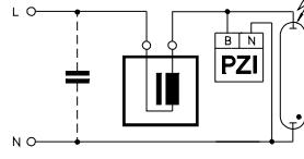
БЗУ для HI ламп, напряжением зажигания 0,9 кВ
