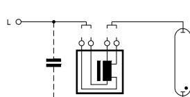
HM лампы [ПРА с двумя альтернативными отводами мощности и напряжения]
