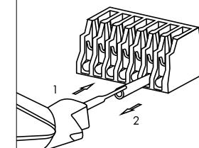
Удаление изоляции проводника для безвинтового контактного зажима  $0,5-1 \text{ mm}^2$ : 8 - 9 мм
