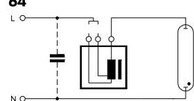
HS ламп с встроенным зажигающим устройством
