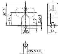
Ламподержатели для ТС-F, ТС-L ламп
