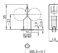
Ламподержатель для ТС-L ламп
