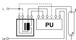
ПРА с двумя отводами мощности и двумя отводами напряжения ( $I_{ST} = 0 \text{ В}$  или  $I_{ST} > 0 \text{ В}$ )
