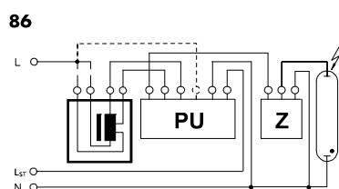
ПРА с двумя отводами мощности и двумя отводами напряжения ( $I_{st} = 0 \text{ В}$  или  $I_{st} > 0 \text{ В}$ )
