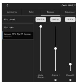
Вы можете использовать вкладку настройки сцены для канала 1 (жалюзи) и канала 2 (планки), чтобы указать расстояние в %, на которое должны перемещаться жалюзи, а также рабочий угол планок жалюзи.
