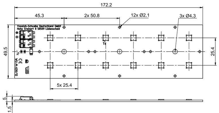
Alle Löcher mit  $\varnothing 2,1$  mm sind Befestigungslöcher für Optiken. | Alle Löcher mit  $\varnothing 4,3$  mm sind Befestigungslöcher für die Platine.
