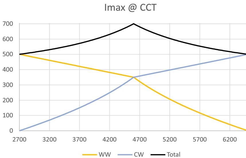
Mischströme: 500mA pro Kanal (Einzelkanal), 350mA pro Kanal (Mischströme).
